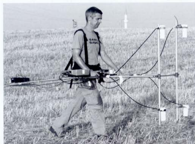
Abb. 1 Zwei-Spur Caesiummagnetometer in Gradientenanordnung im Feld.
