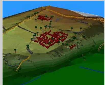
Fondations reconstruites en modèle de terrain 3D avec GIS à partir de mesures au radar
