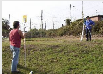
Enregistrement d'une surface d'investigation avec la station totale (Zeiss EltaR55)
